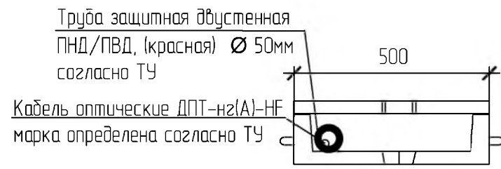
Укладка оптического негорючего кабеля в защитной трубе
